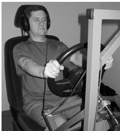
Рис. 6.1. Экспериментальный стенд, позволяющий моделировать одновременные воздействия шума автомобильного двигателя, вибрацию кресла и вибрацию руля (LVA, INSA de Lyon)
