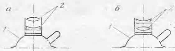
Рис. 2. Схематическое изображение глазных присосок с оптическими системами, использованными для увеличения (*a*) и уменьшения (*б*) угла проекции внешнего объекта на сетчатке. 1 — Корпус присоски с центральным тубусом; 2 — оптическая система, состоящая из положительной и отрицательной линз
