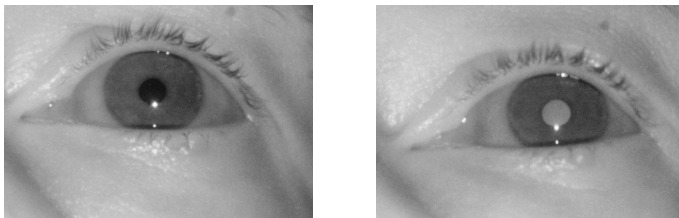
Рис. 30. Изображение глаза в ближнем ИК-диапазоне при разном расположении источника света. Фото: Центр экспериментальной психологии МГППУ, оригинальная установка
